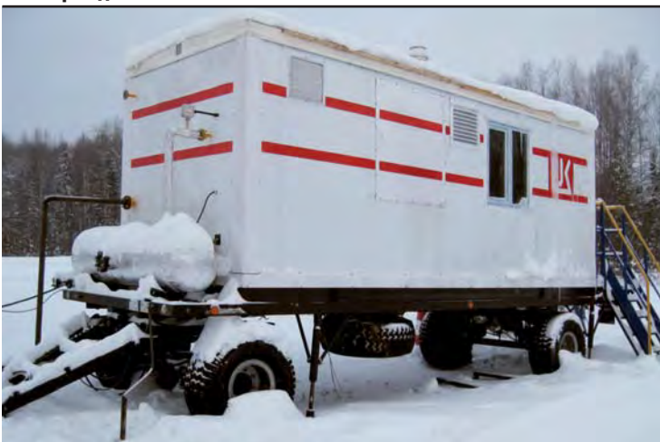
Рис. 6. Мобильная микротурбинная электростанция на месторождении ООО «ЛУКОЙЛ-ПЕРМЬ»
